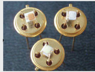
Sensori di sostanze volatili e gas per applicazioni ambientali realizzati con micro- e nano-tecnologie
